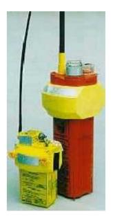
De couleur jaune ou orange pour faciliter le repérage visuel, étanches à une profondeur de 10 mètres, elles doivent pouvoir fonctionner pendant 48 heures et être éjectées automatiquement de leur conteneur à moins de 4 m de profondeur (RLS de pont).
